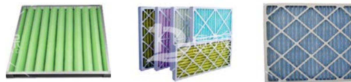
初效过滤器适用于空调系统的初级过滤，主要用于过滤  $5\mu\text{m}$  以上尘埃粒子。初效过滤器有板式、折叠式、袋式三种样式，外框材料由纸框、铝型材框、镀锌板框，过滤材料有无纺布、尼龙网、活性炭滤材、金属孔网、铝轧网等。
