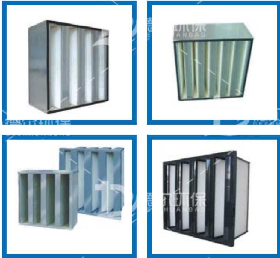
正高效密褶式过滤器采用优质塑料及镀锌钢板或铝材版做框架，以超细化纤或下班纤维滤纸做滤料。其突出特点是有效过滤面积大，阻力低，占有空间小，坚固耐用，无毒无味，可做高效空气过滤器的预过滤器用，从而延长高效过滤器的使用寿命。
