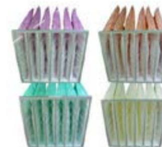
中效过滤器广泛适用于空调系统的中级过滤，适应于含尘浓度高的场合，采用优质化纤无纺布滤料，容尘量大。主要用于过滤 1-5 $\mu$ m 的尘埃的粒子，具有阻力小、风量大的优点。中效过滤器有袋式和框式、组合式等。
